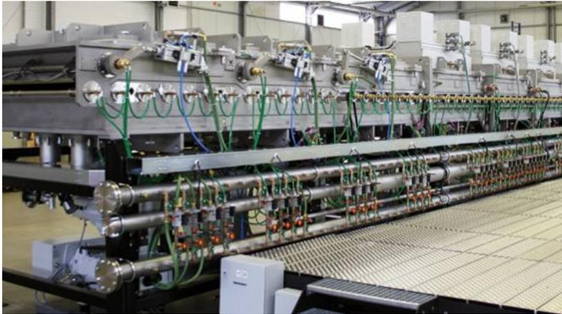
Die zu beschichtenden Gläser werden auf über 550°C aufgeheizt u. nach der Beschichtung kontrolliert unter Vakuum abgekühlt
