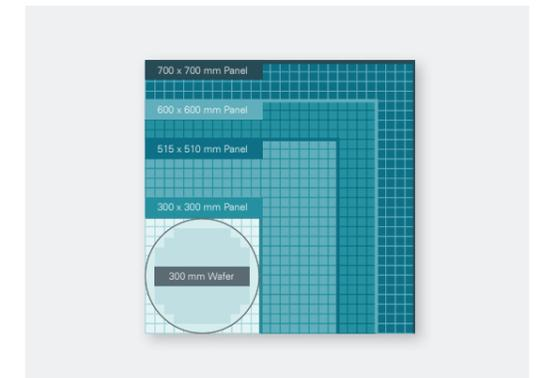
為了提高生產效率並降低成本，晶片製造過程中的載具已由傳統的圓形晶圓轉向方形材料，包括玻璃、有機基板、不鏽鋼板等。這種轉變的封裝材料的面積從 510 mm x 515 mm 和 600 mm x 600 mm 不斷發展，目前已達到最大面積 700 mm x 700 mm，相當於 12 吋玻璃晶圓的 7 倍。使用方形載具不僅提供更大的製造靈活性，確保高效率的製程，使更多的晶片能夠被容納於同一封裝區域內。
