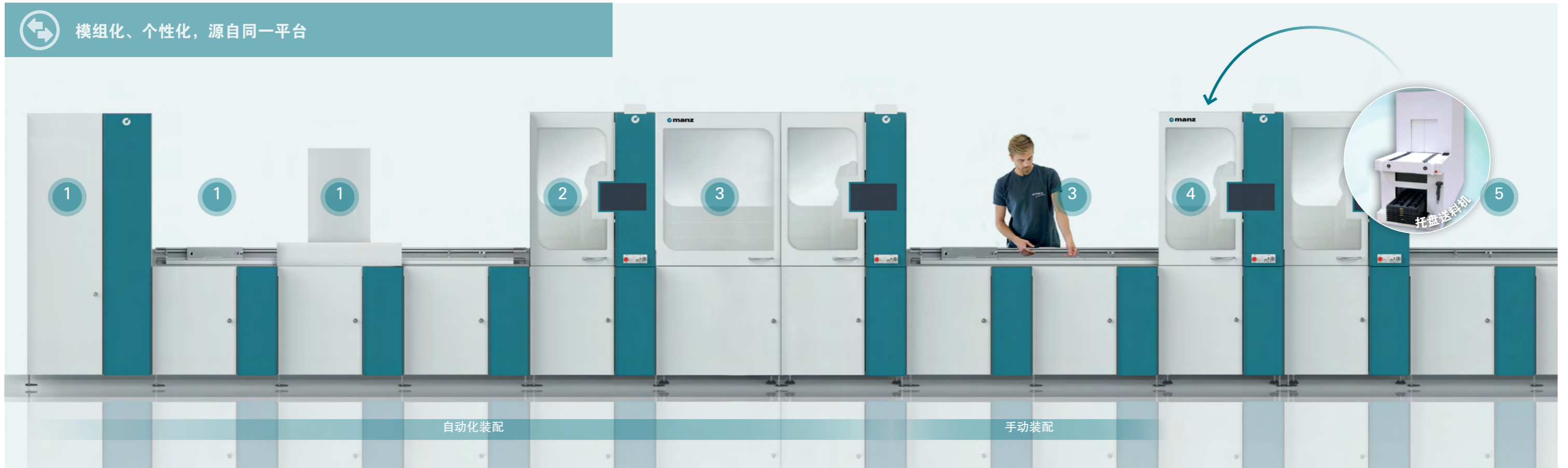
模块化和最大程度的灵活性: 标准模式包含装卸单元、输送带、升降机与制程站, 能够独立进行安装、改造与更新。
