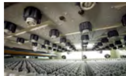
上图: 显影制程设备 中图: 喷洒直喷板面, 无遮蔽快拆式喷嘴 下图: 快拆式喷嘴
