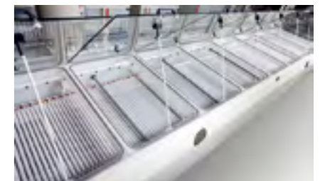
上图：水平除胶渣化学铜设备 中图：SWL & DSM 水刀 下图：化学铜
